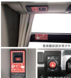
ドライバーに異常が発生した場合、運転席と客席最前部に設置された非常ボタンにより、車両を緊急停止させる安全装置です。
